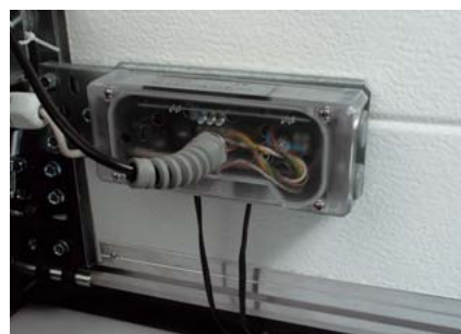
Optosensor bei elektrischem Antrieb mit Impulssteuerung
